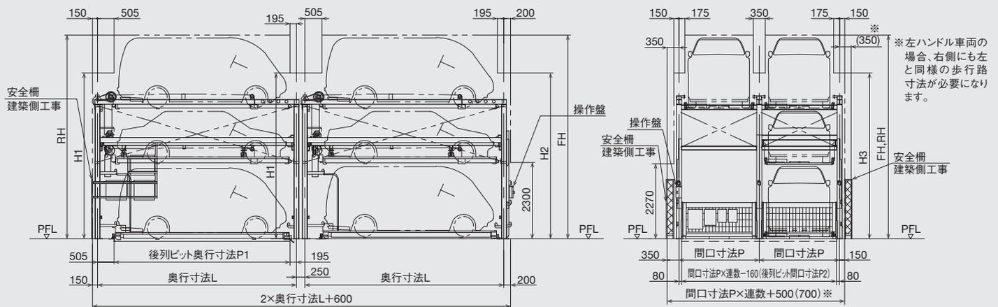
注)本図は各パレットの定位置状態を示し、通常の状態では昇降するパレットのいずれかが乗込み位置にある場合があります。
