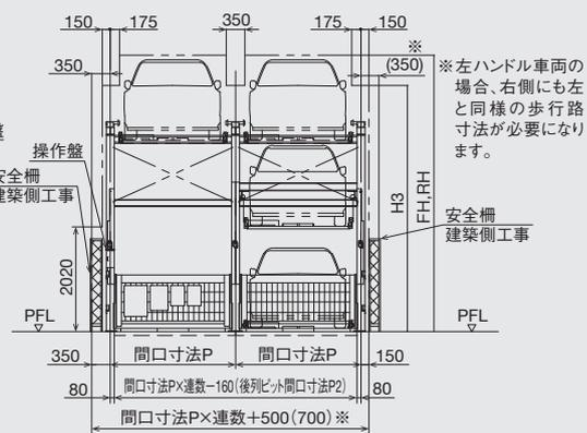
注)本図は各パレットの定位置状態を示し、通常の状態では昇降するパレットのいずれかが乗込み位置にある場合があります。
