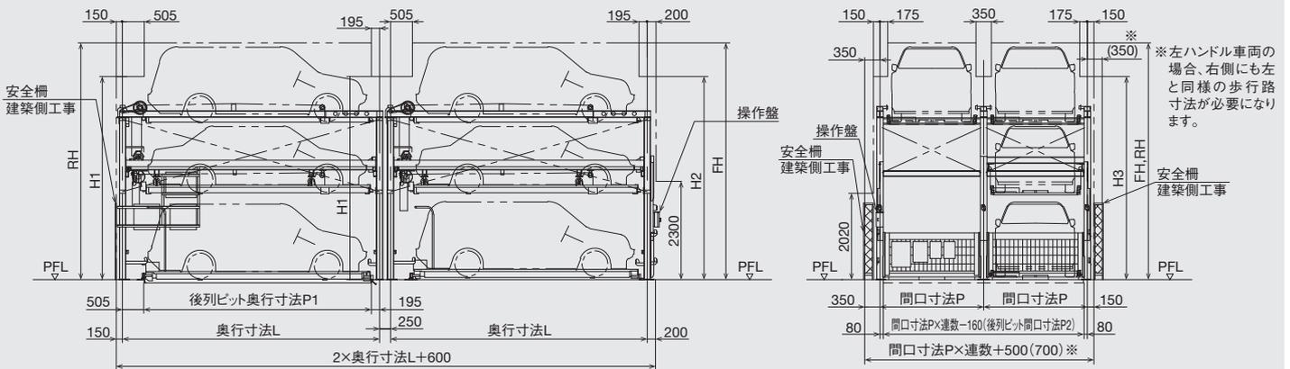
注)本図は各パレットの定位置状態を示し、通常の状態では昇降するパレットのいずれかが乗込み位置にある場合があります。
